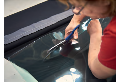
Die störrische Scheibenfolie ist stabil und muss per Hand zugeschnitten werden. Wichtig: Der TÜV fordert eine Prüfnummer
