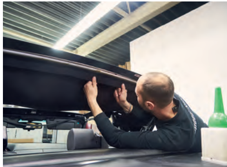
Fingerübungen: Beim Verkleben des Verdeckstoffs muss Michele viel Körperkraft einsetzen, um die korrekte Spannung zu erreichen
