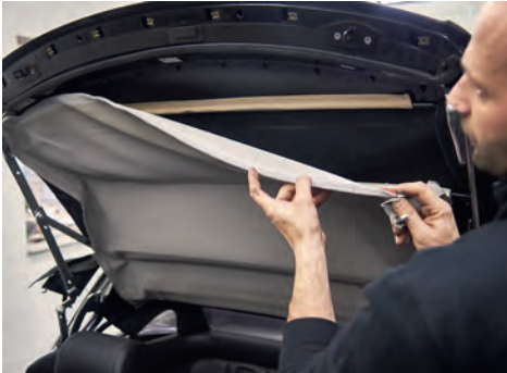
Bei der Demontage des Innenhimmels muss Michele bei diesem R 129 besonders aufpassen – der Besitzer will ihn wiederverwenden
