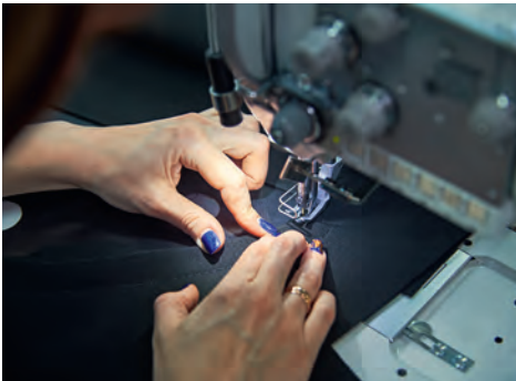
Auch das Vernähen des mehrlagigen Verdeckstoffs braucht Erfahrung und starke Finger, um die Lagen korrekt auszurichten
